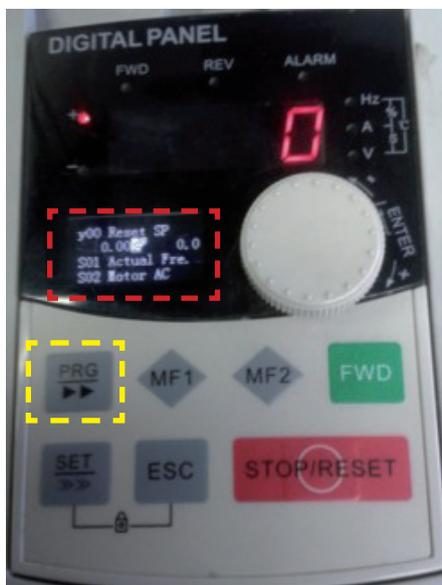
c) Premere PRG e ruotare la manopola fino a leggere il valore 5 nel display superiore
