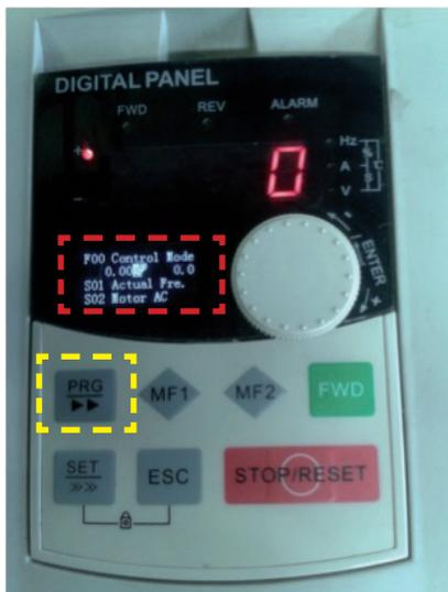
d) Ruotare la manopola fino a leggere nel display inferiore F10 Dec. Time
