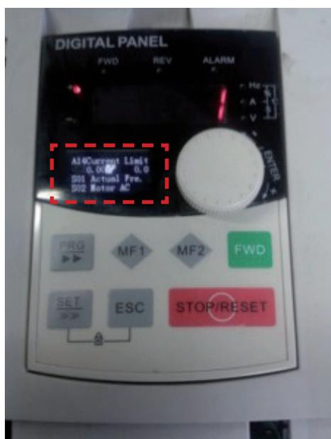
Nel processo di funzionamento, quando la corrente del motore supera il valore impostato A16, il motore rallenta il funzionamento secondo il tempo impostato da A15, fino a che la corrente scende al di sotto del valore impostato.
