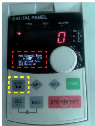
c) Ruotare la manopola fino a leggere nel display inferiore “F09 Acc. Time”
